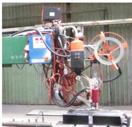
Рисунок 3 – Головка ЭШН лабораторной установки для выполнения наплавки ООАП
