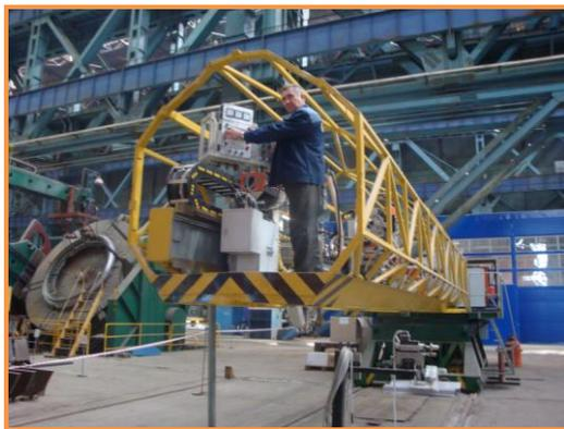
Рисунок 4 – Оборудование для выполнения ООАП методом ЭШН двумя головками
