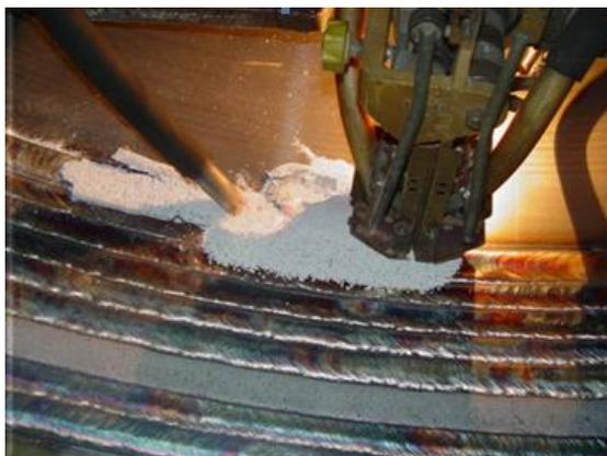
Рисунок 1 – Автоматическая дуговая наплавка под флюсом ленточным электродом (АДНФ)
