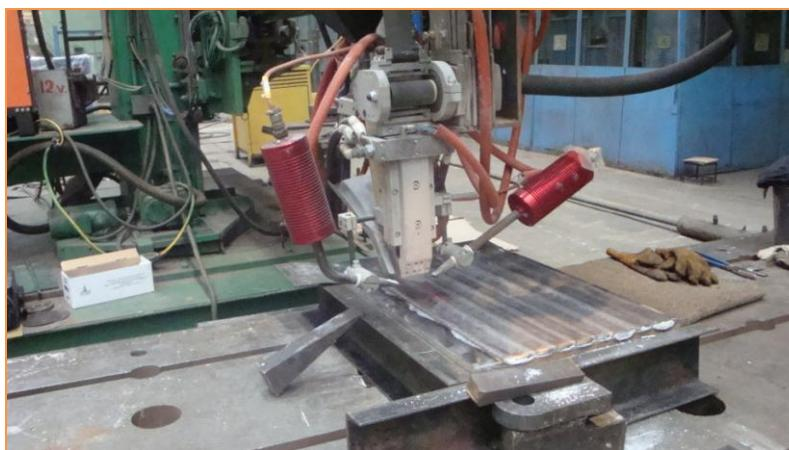
Рисунок 2 – Головка ЭШН для выполнения наплавки ООАП
