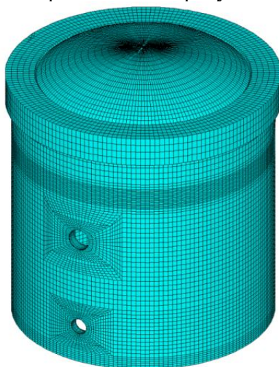
Рисунок 1 – Конечноэлементная модель защитной оболочки АЭС (188652 линейных объемных элементов и 208716 узлов)
