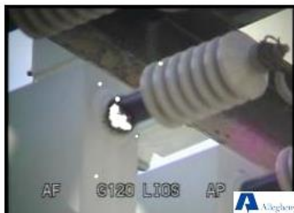
Рисунок 1 – Корона в месте соединения втулки и конденсатора
