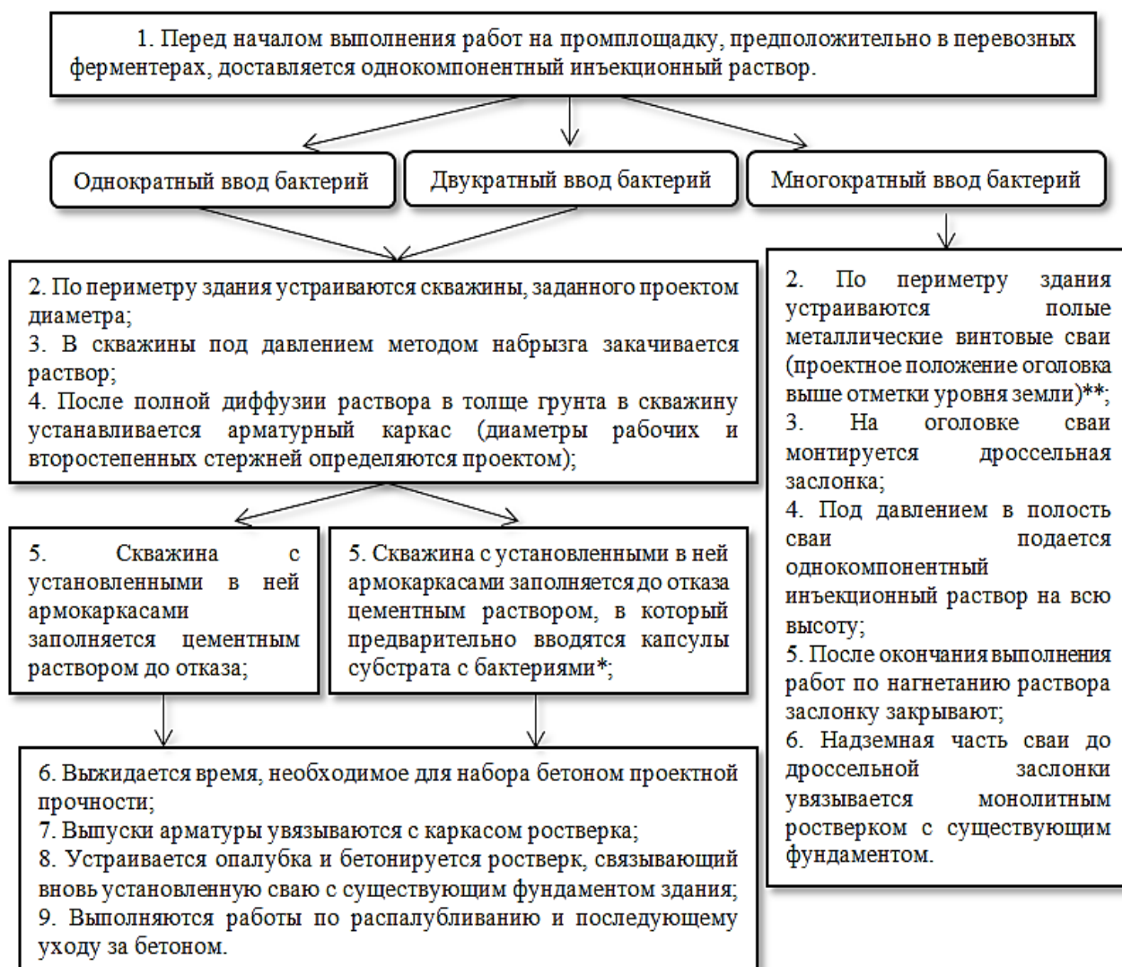
Рисунок 1 – Блок-схема технологических этапов процессов инъектирования
