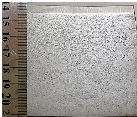
Рисунок 1 – Макроструктура колена с однопроходной электрошлаковой наплавкой внутренней поверхности (вверху)
