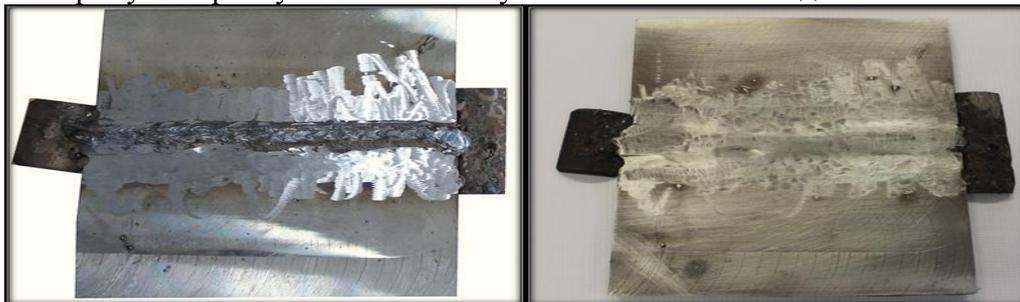
Рисунок 1 – Внешний вид образца КСС после сварки (слева). На фото справа показан образец после снятия усиления шва
